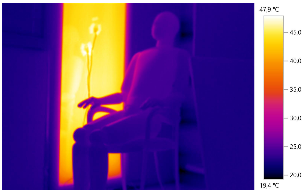
Hőkamerás kép a mérésről az üveg fűtött oldalán
